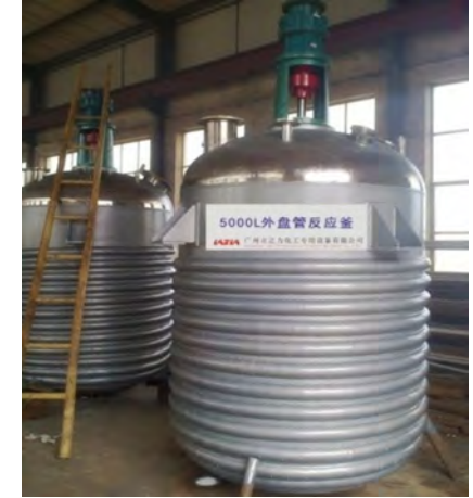
Cuve avec double manteau en demi-tube
